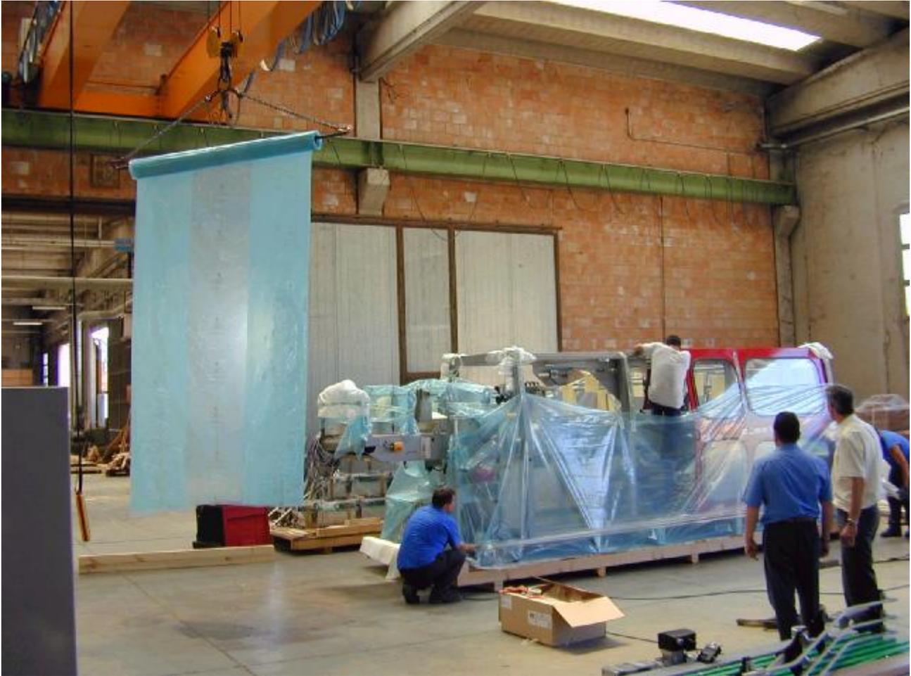
L'eccedenza del film anticorrosivo posizionato sul pianale viene fatto aderire al macchinario fissandolo con del film estensibile. Nel contempo si prepara il film VpCI per la copertura
