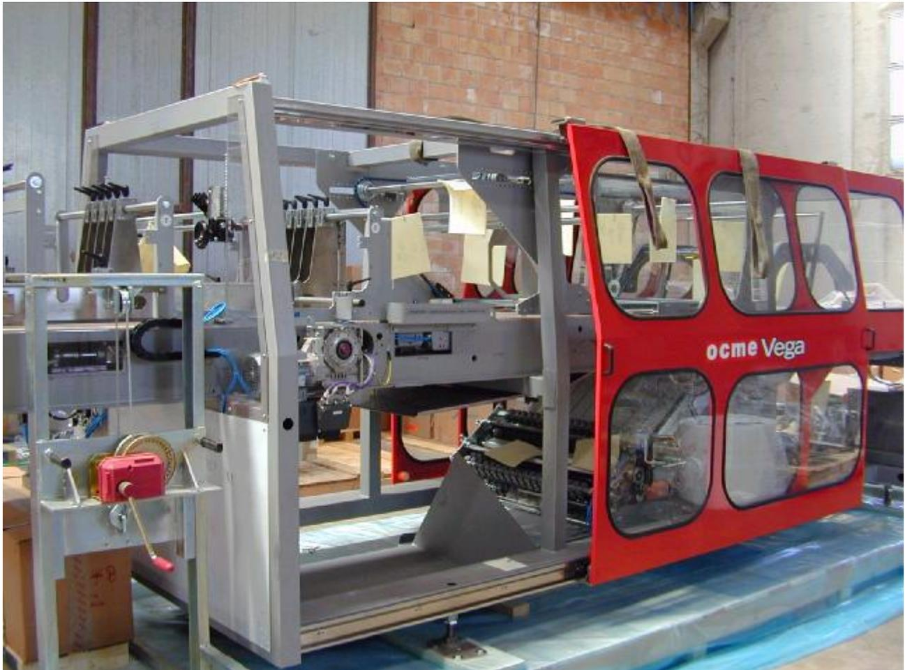
Al fine di aumentare la concentrazione di VpCI all'interno dell'imballaggio vengono posizionate le spugne emittitrici di vapori anticorrosivi VpCI.
